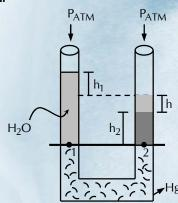
$$\begin{split} P_1 &= P_2 \\ P_{MM} + P_{H_2O} &= P_{H_2O}^1 + P_{Hg} + P_{MM} \\ (D_{H_2O})(g)(h_1 + h_2 + h) &= (D_{H_2O})(g)(h) + (D_{Hg})(g)(h_2) \\ (1)(h_1 + 1 + M) &= (1)(M) + (13,6)(1) \\ h_1 &= 12,6 \text{ cm} \end{split}$$
